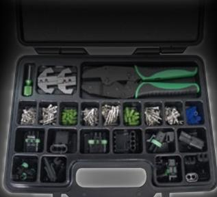
MODEL NO. **9478** **220PC. WEATHER PACK INTERCHANGEABLE RATCHETING CRIMPING TOOL & ACCESSORY SET**
